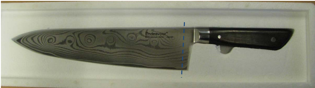
Figur 1. Foto af kniv ved modtagelse. Metallografisk snit lagt ved stiplede blå linje jf. Figur 2.
